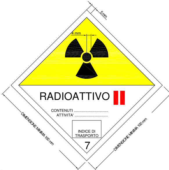
Figura 3: Etichetta della categoria II-GIALLA. La larghezza minima della linea del bordo interno che forma il rombo deve essere di 2 mm. Il colore dello sfondo della metà superiore dell'etichetta deve essere giallo e della metà inferiore bianco, il colore del trifoglio e delle scritte deve essere nero e il colore delle barre della categoria deve essere rosso.
