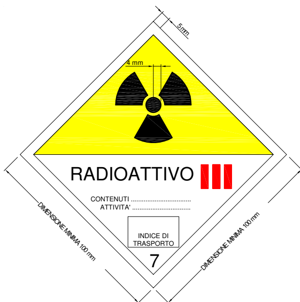
Figura 4: Etichetta della categoria III-GIALLA. La larghezza minima della linea del bordo interno che forma il rombo deve essere di 2 mm. Il colore dello sfondo della metà superiore dell'etichetta deve essere giallo e della metà inferiore bianco, il colore del trifoglio e delle scritte deve essere nero e il colore delle barre della categoria deve essere rosso.
