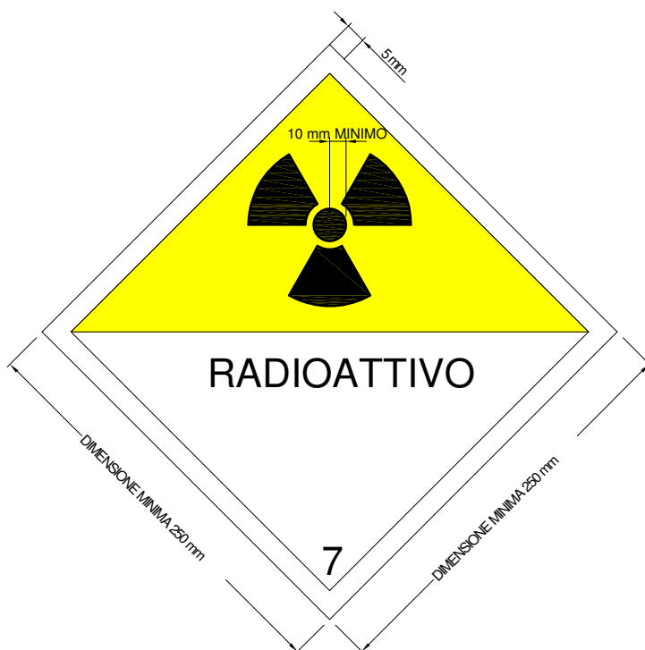
Figura 7: Placca. Ad eccezione di quanto permesso al paragrafo 571 le dimensioni minime devono essere come mostrato; quando si usano dimensioni diverse devono essere mantenute le relative proporzioni. Il numero “7” deve essere alto non meno di 25 mm. Il colore dello sfondo della metà superiore della placca deve essere giallo e della metà inferiore bianco, il colore del trifoglio e delle scritte deve essere nero. L’uso della parola “RADIOATTIVO” nella metà inferiore è facoltativo, al fine di consentire l’uso alternativo di questa placca per riportare il numero ONU appropriato alla consegna.
